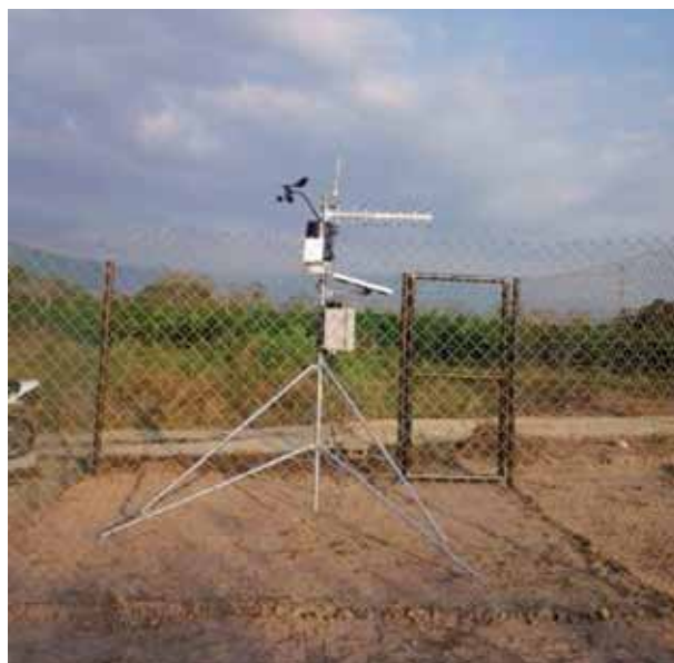
Figura 4. Estación meteorológica automática.
