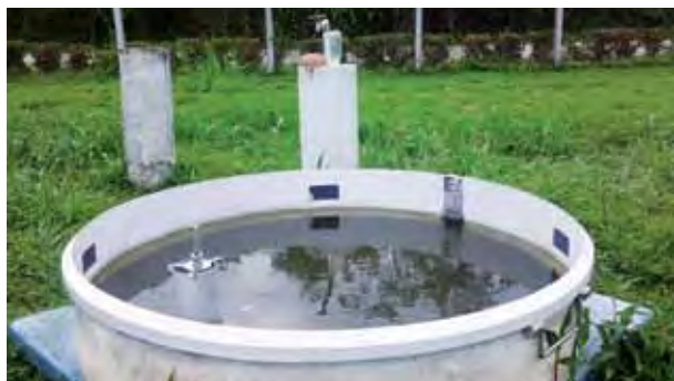
Figura 20. Tanque de evaporación.
