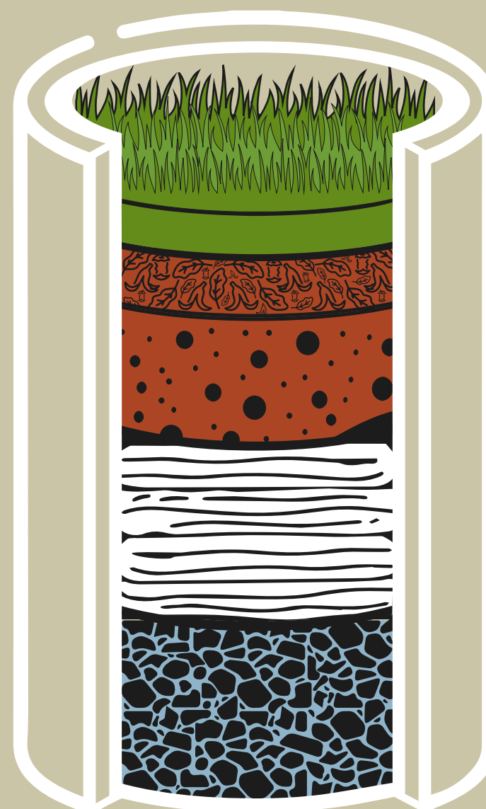
Figura 89. Composición de una cama biológica
