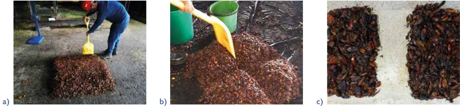
**Figura 14.** Muestra compuesta de la MPD: a) homogenización; b) cuarteo; c) submuestras de 1.000 g
