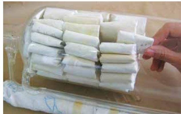
**Figura A.3.** Llenado del sistema Soxhlet de múltiples muestras.
