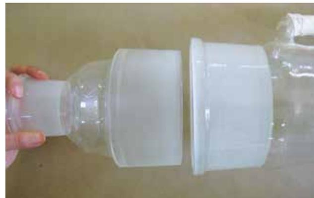
**Figura A.2.** Ejemplo de conexiones entre el cuerpo y el condensador del sistema Soxhlet de múltiples muestras.
