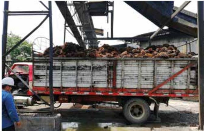
Figura 8. Vehículo dispuesto para determinar el peso de las tusas
