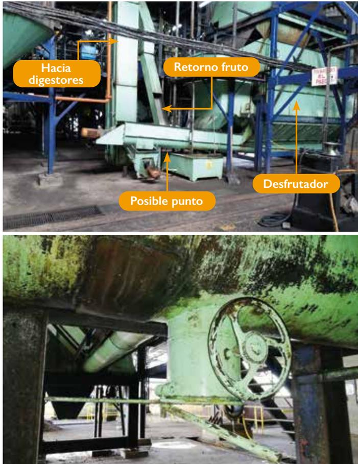
**Figura 10.** Selección y ubicación del punto de muestreo para la MPD sobre el sinfín transversal. Accesibilidad, representatividad y seguridad
