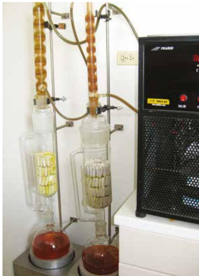
**Figura A.4.** Ejemplo de sistema Soxhlet de múltiples muestras con sistema de enfriamiento y recirculación de agua para los condensadores.
