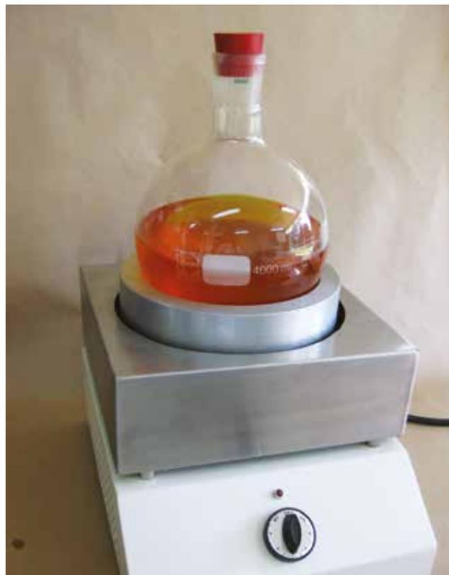
**Figura A.1.** Ejemplo de balón y plancha de calentamiento usado en sistema Soxhlet de múltiples muestras.
