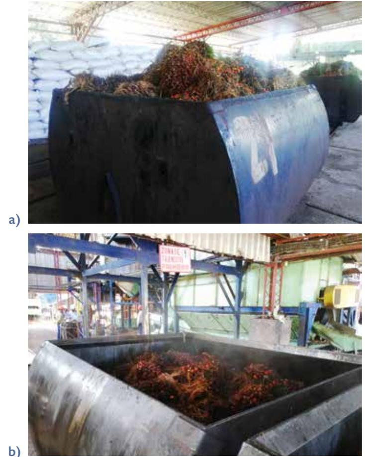
**Figura 3.** Reducción de altura de las pilas de racimos, debido a la pérdida de humedad por el proceso de esterilización; a) racimos de fruta fresca; b) racimos de fruta esterilizados
