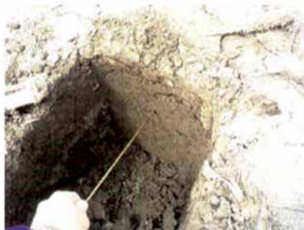
Figura 7. Determinación de la resistencia a la penetración.
