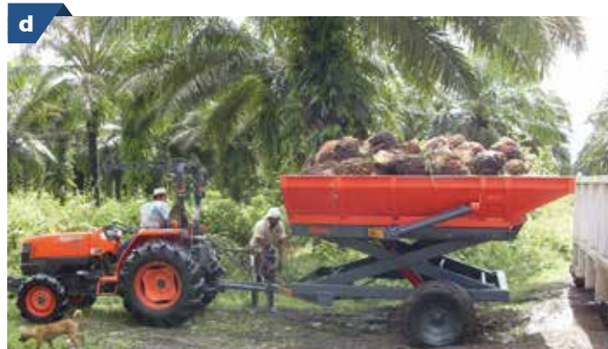
a. Transporte de racimos con carretas – carramato haladas con tractor; b. Transporte de racimos en cablevía; c. Transporte de racimos en carreta halada con mototriciclo; d. Transporte de racimo tractor con carreta de alce hidráulico.
