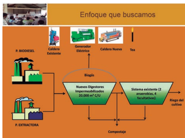
Figura 14. Esquema de aprovechamiento de biomasa líquida y sólida en la planta Yaguarito de Aceites Manuelita S.A.
