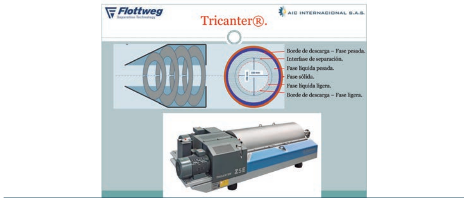
Figura 9. Esquema de funcionamiento del Tricanter.
