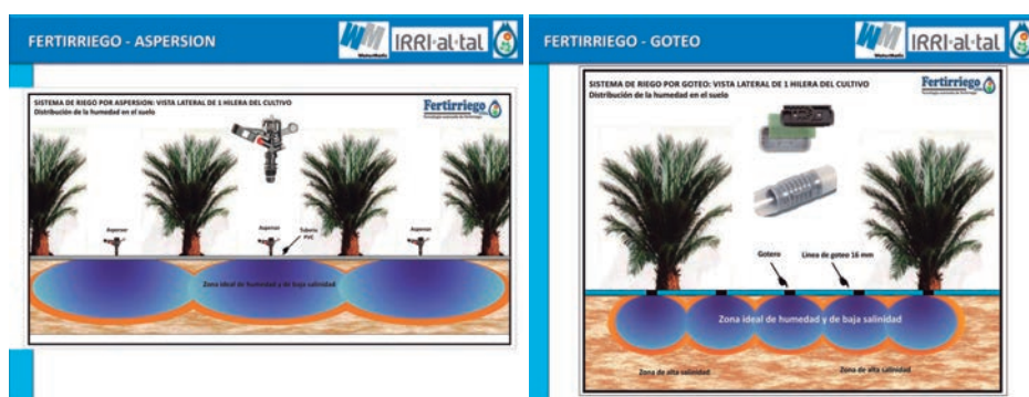
Figura 21. Opciones de sistemas de aspersión para fertirriego de palma de aceite según la humedad y salinidad del suelo.
