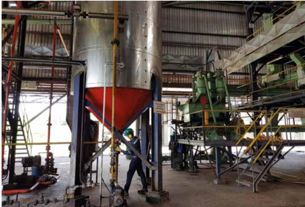
Figura 20. Operador realizando purga al sedimentador.
