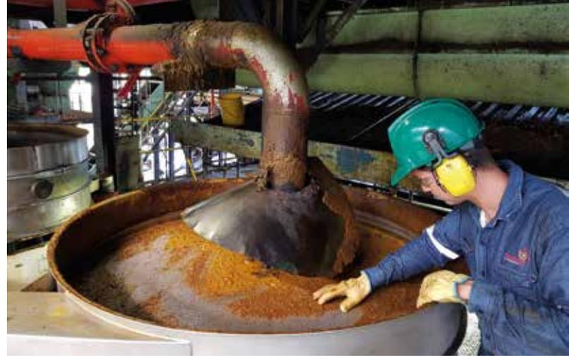
Figura 11. Operador revisando el estado de una malla del tamiz circular.
