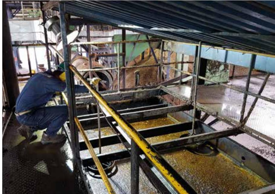
La clarificación estática corresponde a la etapa en la que se lleva a cabo la separación del aceite contenido en el licor de prensa. En este proceso el licor es diluido, tamizado y calentado para separar el aceite mediante decantación en tanques (preclarificador y clarificador).
