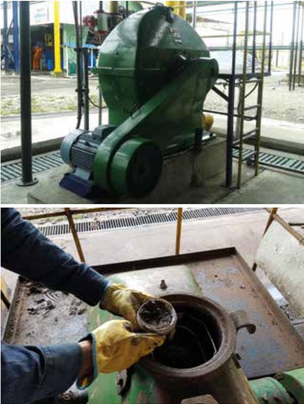
Figura 27. Operador realizando inspección y limpieza de boquillas.
