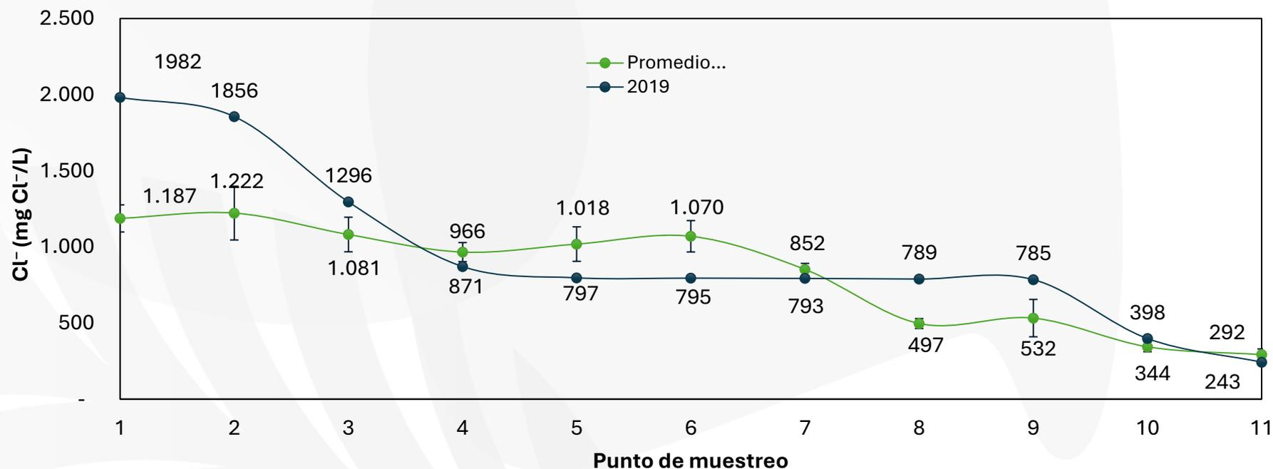
Comportamiento de los iones Cl<sup>-</sup> en los efluentes de la planta de beneficio. Comparativo entre el promedio del seguimiento realizado durante el 2023 y el análisis realizado en 2019.
