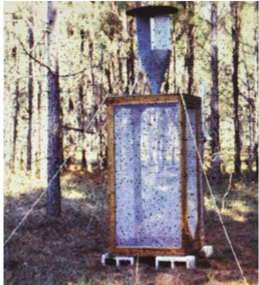
Figura 1. Trampa de luz negra, de longitudes de onda muy cortas cercanas a la ultravioleta, a la que muchos insectos nocturnos son atraídos. Foto: A. Bustillo |
