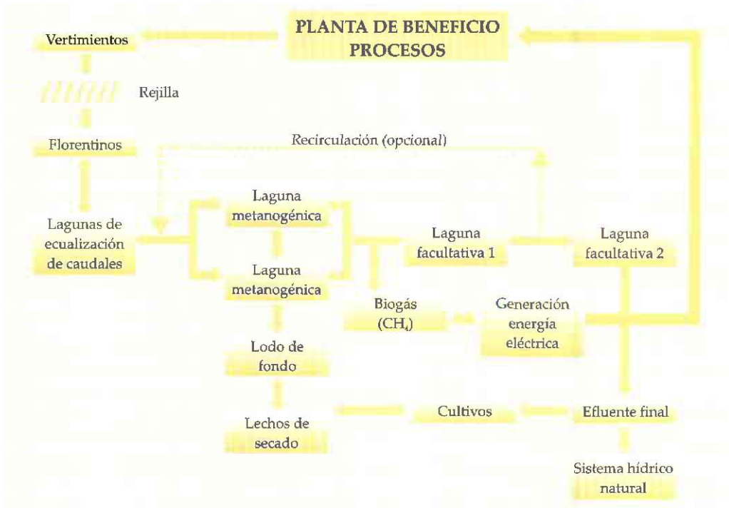
Figura 6. Diagrama de flujo típico del tratamiento y manejo de las aguas residuales
