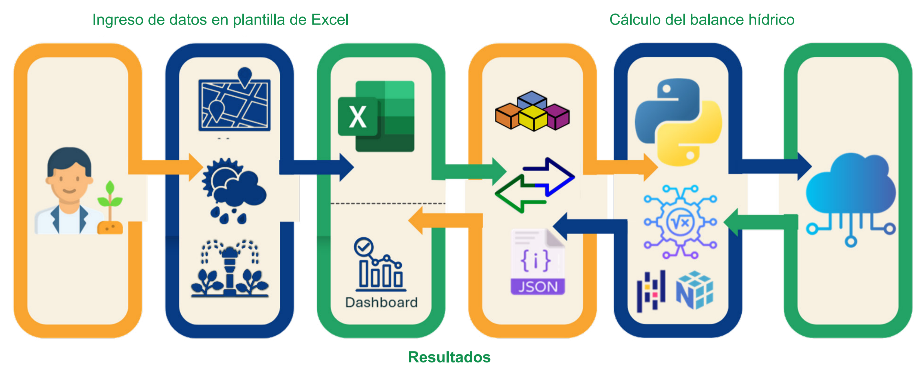
Figura 2. Proceso de datos desde Excel a la nube y de vuelta hasta el Dashboard.
