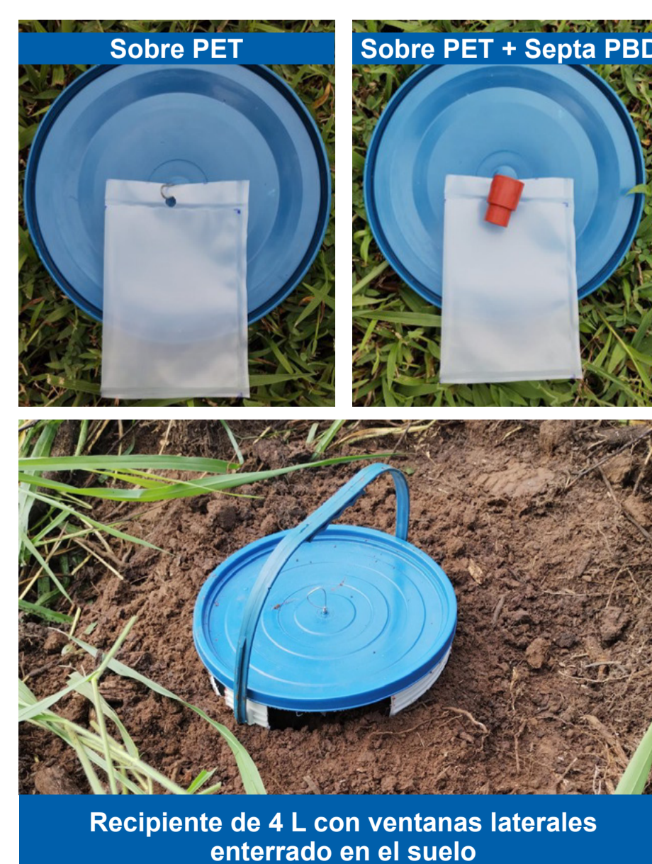
Figura 3. Diseño y ubicación de difusores y trampas para la captura de adultos de S. aloeus bajo condiciones de campo.
