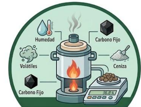
ANÁLISIS PRÓXIMO: COMPOSICIÓN TÉRMICA Y MINERAL Determinación de Humedad, Volátiles, Carbono Fijo, Ceniza, y Poder Calorífico
