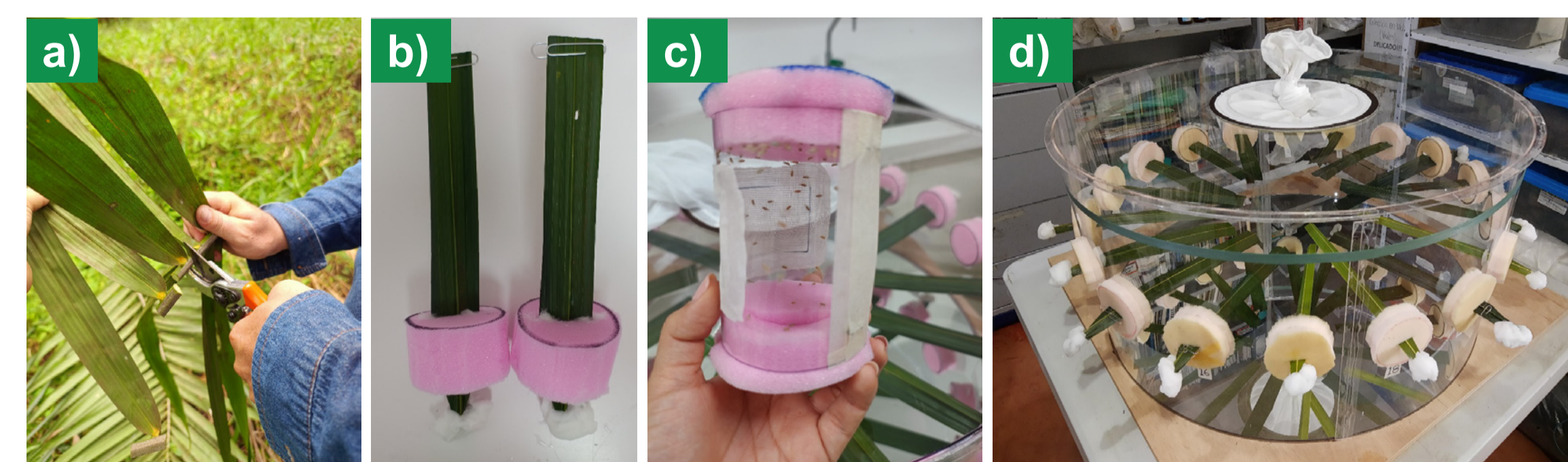
Figura 1. Detalles de metodología para evaluar antixenosis, pruebas de libre selección de genotipos de palma de aceite para H. crudus . a) corte de foliolos en campo; b) preparación de foliolos para introducirlos en la cámara acrílica; c) cilindro con adultos de H. crudus ; d) cámara acrílica lista para las evaluaciones.
