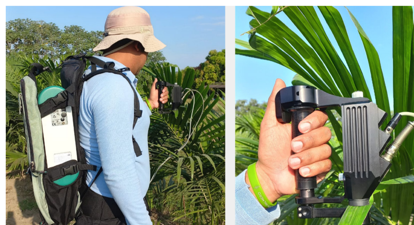
Figura 2. Medición de respuesta espectral con espectrorradiómetro.
